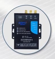
型号: AC-701 发射功率: 2W
