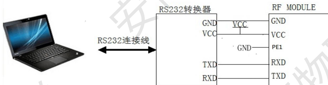
图 9.1 无线模块和电脑连接示意图（TTL）
