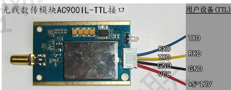
图 7.2 无线模块和用户设备连接示意图（RSTTL）
