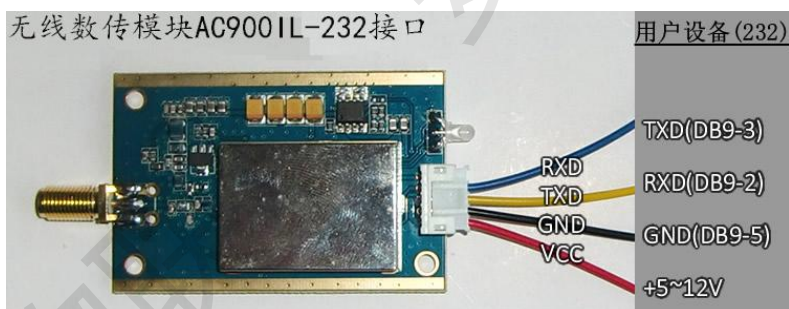
图 7.2 无线模块和用户设备连接示意图（RS232）
