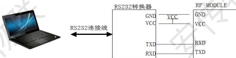
图 8.1 无线模块和电脑连接示意图（TTL）
