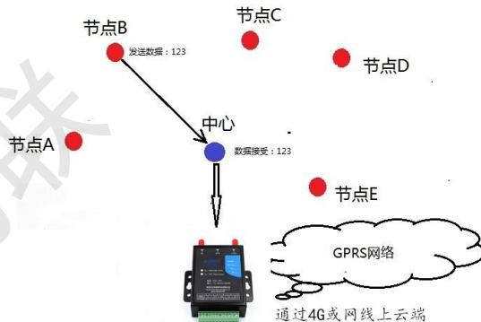
组网路由的扩展：在星型组网情况下如果距节点距离太远，可以在中间放置一个中继。只要对模块设置一下就可以通过中继进行接力传输数据，并且还能保证了原有的低功耗性能。
